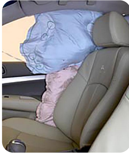
Bolsa de aire lateral que protege la cabeza y el pecho 2
