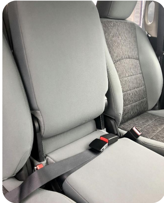
Cinturón de regazo sin retractor
