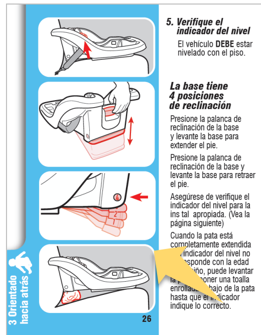
Ejemplo de ajuste de reclinación del asiento de seguridad
