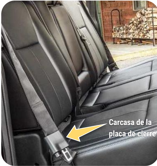
Cinturón de hombro inflable en el que se ve una correa más gruesa y una carcasa de la placa de cierre de gran tamaño
