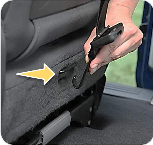
Un anclaje de sujeción superior sin marcar en la parte inferior de un asiento de vehículo
