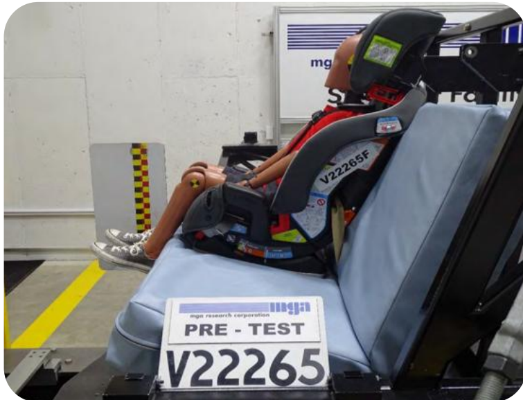
Prueba con plataforma deslizable
