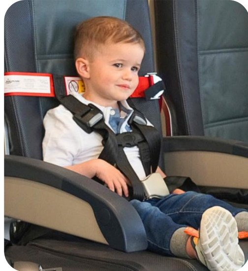
CARES agrega sujeción para la parte superior del cuerpo al cinturón de regazo de un avión.
