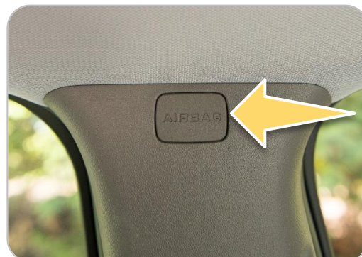
Marca de la bolsa de aire tipo cortina cerca de la línea del techo
