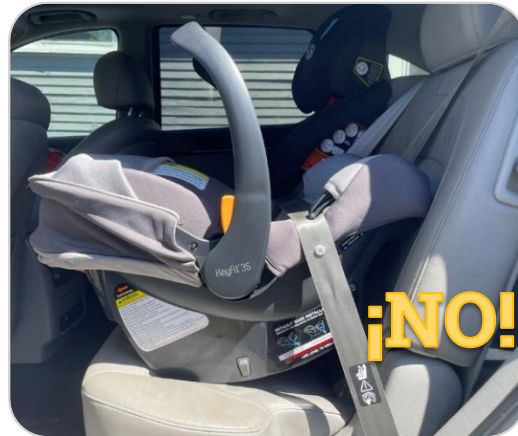
Asiento de seguridad para bebé que está demasiado reclinado hacia atrás
