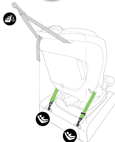
Instalación orientada hacia adelante usando anclajes inferiores y correa de sujeción superior
