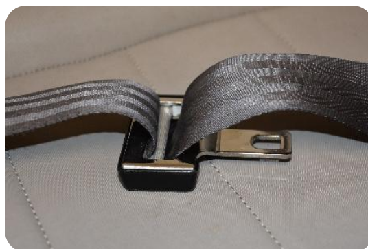
Placa de cierre con bloqueo, vistas frontal y trasera
