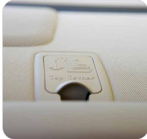
Una marca con un símbolo y palabras en la solapa de cubierta de un anclaje de sujeción superior
