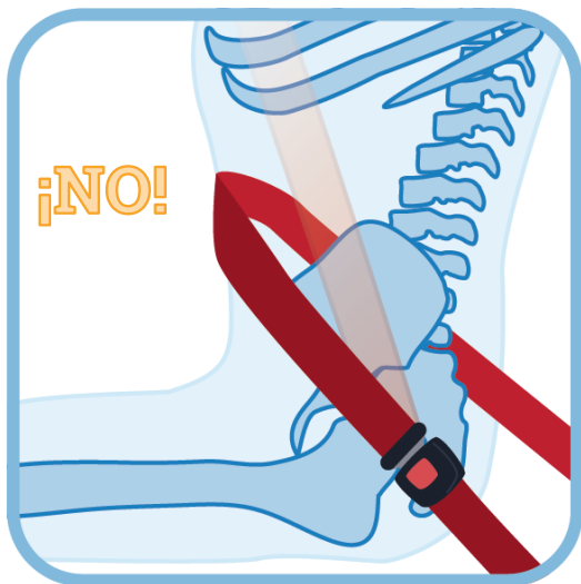
Colocación incorrecta del cinturón de regazo en un niño encorvado en el asiento del vehículo
