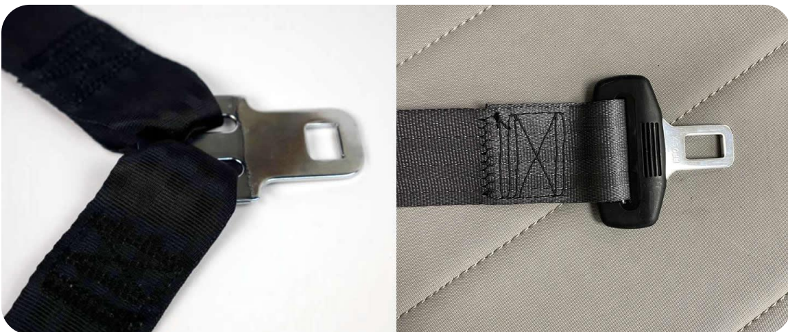
Placa de cierre cosida en el cinturón de hombro y regazo (izquierda) y en el cinturón de regazo (derecha).
