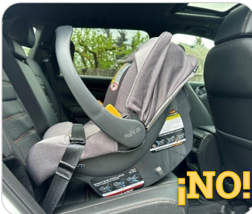
Asiento de seguridad para bebé que está demasiado vertical
