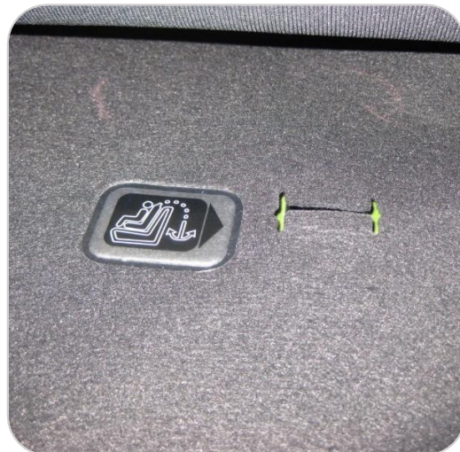
Anclaje de sujeción superior bajo la rendija de la alfombra con marca
