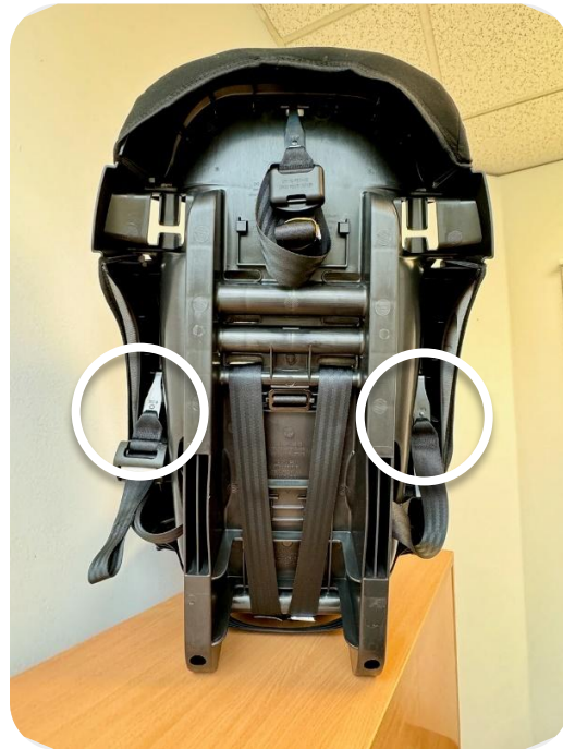
Conector del anclaje inferior y correa, guardados
