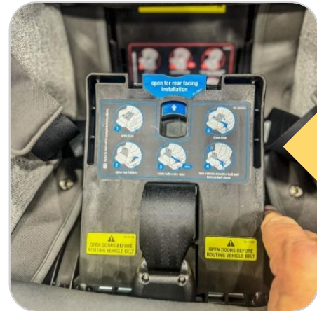
Asiento de seguridad convertible con un dispositivo de tensión
