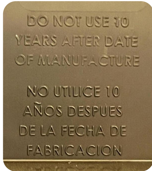
Información sobre vencimiento estampada en la estructura del asiento de seguridad
