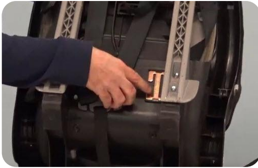
Clip de bloqueo, guardado en el asiento de seguridad
