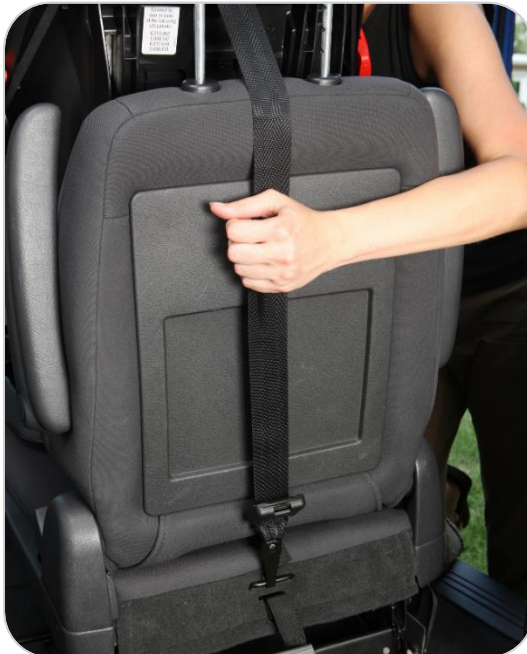
Enrutamiento de la correa de sujeción superior recta por debajo del reposacabezas del vehículo
