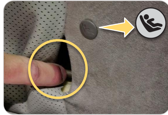
Muchos anclajes inferiores están dentro del pliegue del asiento (no visibles)
